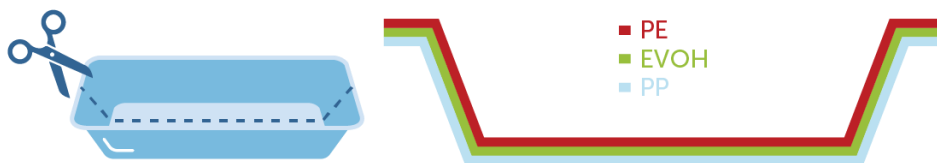
FIGUUR 8: ABSTRACTE VEREENVOUDIGDE WEERGAVE VAN DE DOORSNEDE VAN EEN TRAY VAN MULTI-LAYER, IN DIT GEVAL PP-EVOH-PE. DE EVOH-LAAG LIGT TUSSEN TWEE LAGEN KUNSTSTOF IN EN ZORGT VOOR EEN GASBARRIÈRE.
